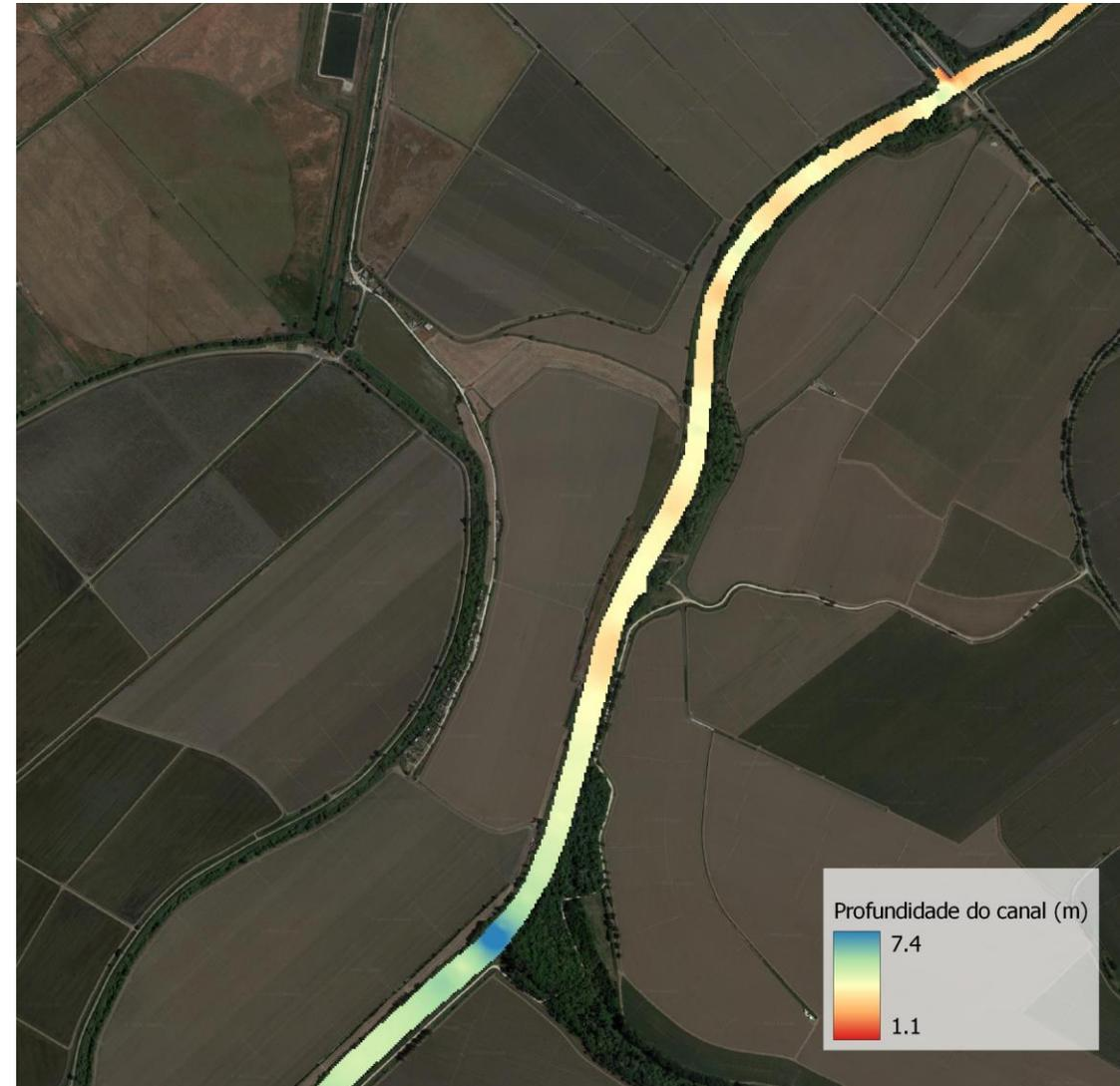
No dia 30 de Agosto de 2021, uma equipa da Agro Analítica com auxílio de um pescador local executou o levantamento batimétrico da Vala da Azambuja. Foi somente possível navegar em cerca de 10 km (de um total de 24 km) devido à abundância de vegetação no leito da vala. Foi levantada a profundidade da vala desde a sua foz até às imediações da Ponte do Reguengo.
