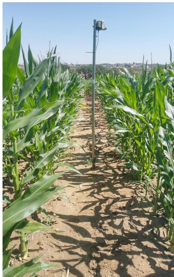
Sondas de 40 a 80 cm de profundidade com opção pluviômetro
